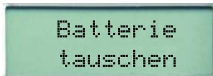
Zum Öffnen des Batteriefaches schieben Sie den Deckel des Batteriefachs kräftig nach unten. Die Batterien können nun gewechselt werden. Bitte verwenden Sie nur Batterien folgenden Typs: Lithium-Zelle CR 2025.
