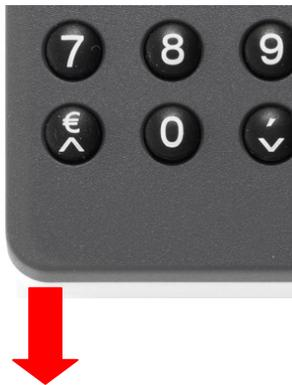
Zur Inbetriebnahme des TAN-Generators ziehen Sie bitte zuerst den Isolationsstreifen in Pfeilrichtung heraus. Der TAN-Generator startet nun sein Betriebssystem und Sie sehen kurz den Gerätenamen und die Versionsanzeige im Display. Dieser Vorgang dauert nur wenige Sekunden, danach erlischt die Anzeige im Display. Ihr tanJack<sup>®</sup> optic SR ist nun einsatzbereit.
