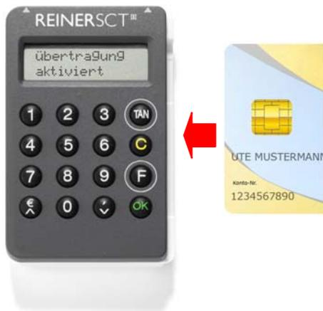
Führen Sie Ihre für das chipTAN comfort -Verfahren registrierte Chipkarte wie abgebildet, mit dem Chip nach vorne in den Kartenschlitz des tanJack<sup>®</sup> optic SR ein.
